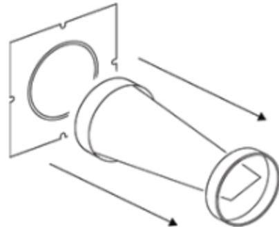
3. Извлеките отработанный фильтр из воздушного канала и утилизируйте его.
