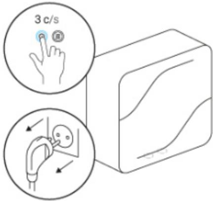
1. Переведите устройство в режим «Ожидание». Осторожно! Перед проведением работ необходимо отключить устройство от сети электропитания, выдернув вилку кабеля питания из розетки.
