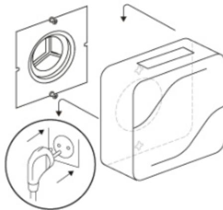
4. Удалите заводскую упаковку с нового фильтра и установите его в воздушный канал. Край фильтра должен быть углублен в воздушном канале на 20 мм.
